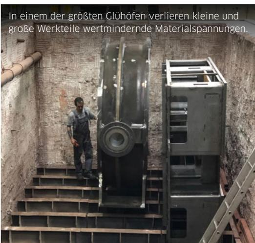
In einem der größten Glühöfen verlieren kleine und große Werkteile wertmindernde Materialspannungen.
